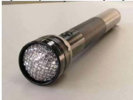
Рисунок 1 – Источник излучения тестовый ИТЭС
